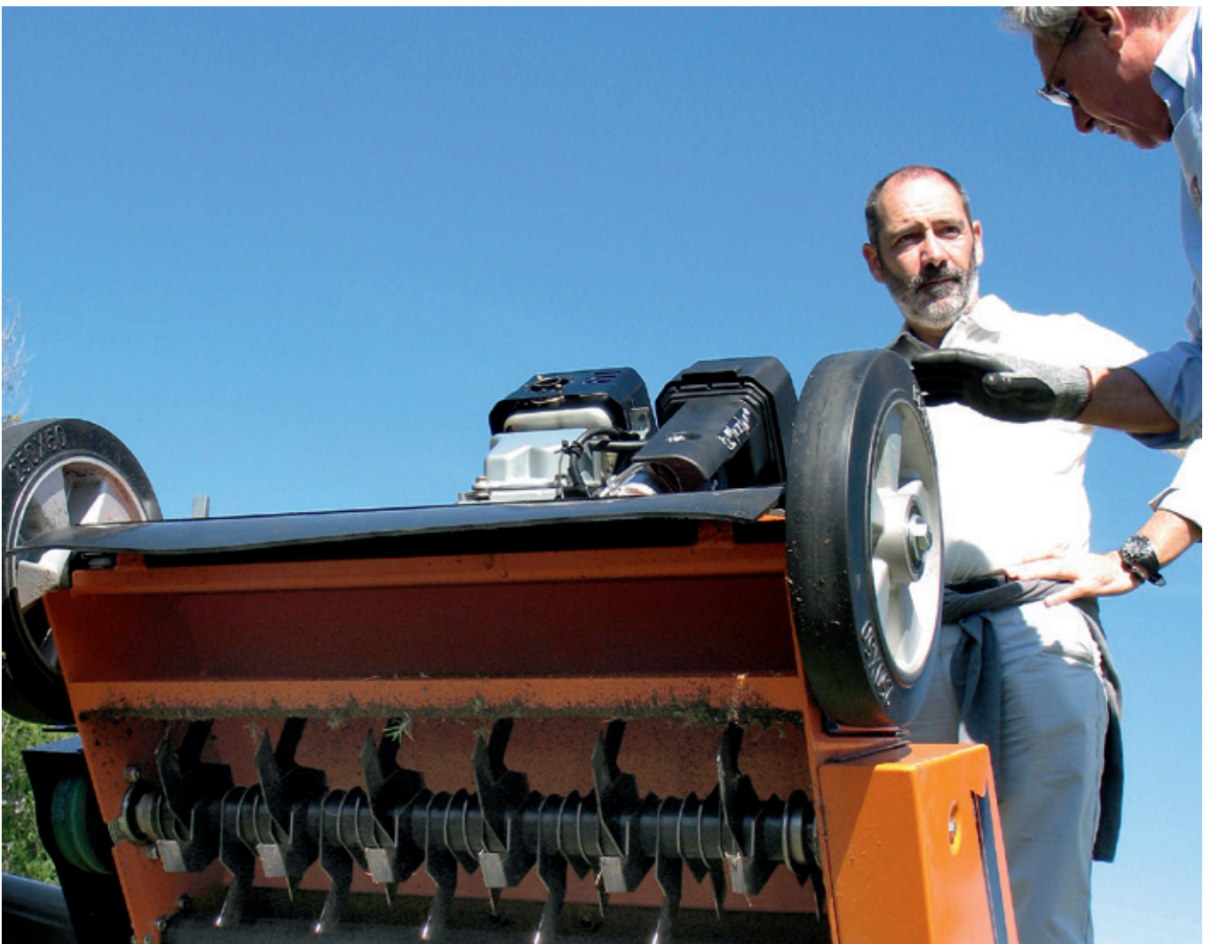
Die selbstschärfenden Double Cut™ Messer holen Moos aus dem Rasen
