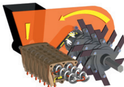
Selbstschärfende Double Cut™ Messer
